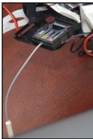
شکل 12: گیرنده رادیویی نصب شده بر کواد در پروژه
