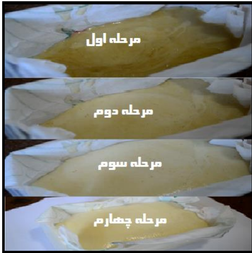
شکل 32: پیشرفت واکنش مواد تشکیل دهنده پلی اورتان
