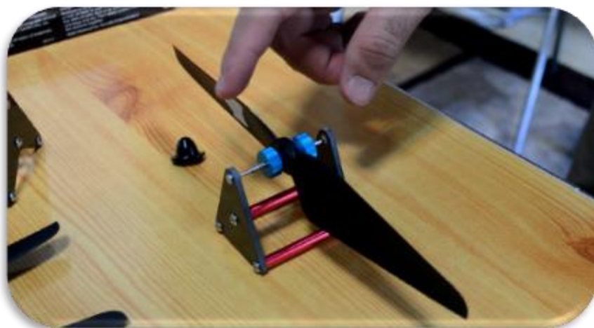
شکل 26: اضافه کردن چسب برای بالانس کردن پره - گره در حالت تعادل استاتیکی قرار دارد
