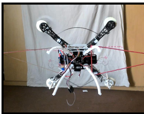
شکل 48: کوادکوپتر در حالت روشن و کنترل شده (دور موتور ۵۰٪)
