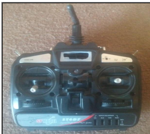
شکل 11: فرستنده رادیویی اسفاده شده در پروژه
