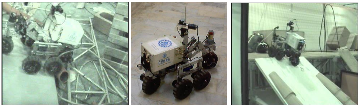
شکل ۱۰- آزمایش ربات امدادگر سدرا در محیطی شبیه سازی شده تخریبی ناشی از وقوع زلزله، ۱۳۸۳
